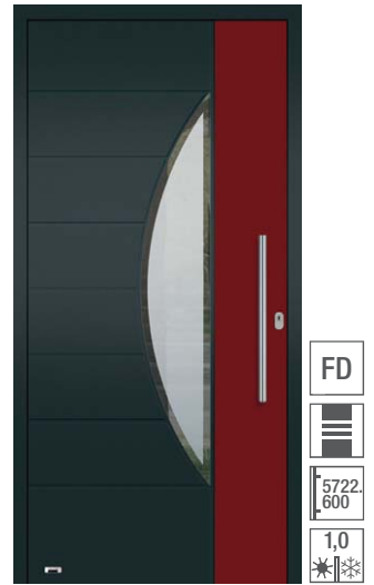
5003 Stoßgriff auf Füllung montiert, vorne: VSG mattiert mit umlaufend klarem Rand, hinten: Float beschichtet, Oberfläche: Grundfarbe Feinstruktur Nightgrey ca. RAL 7016, Applikation RAL 3004 Purpurrot matt.
