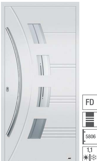
5317 Stoßgriff auf Füllung montiert vorne: VSG 2-Stufen mattiert, mit klaren Streifen und Punkten, hinten: Float beschichtet. Oberfläche: RAL 9016 Verkehrsweiß.
