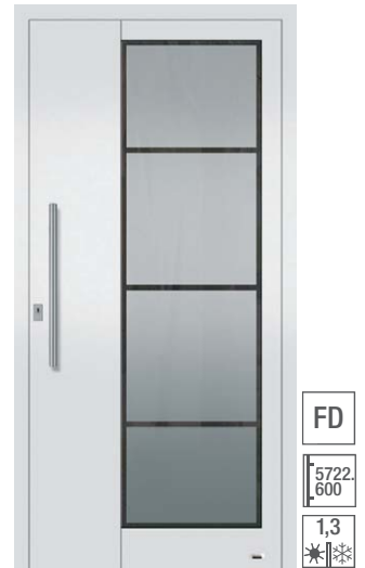
5508 geteilte Sprossen 90 mm, 330 mm breiter Applikation außen aufgebracht, Wärmeschutzisoliertglas, vorne: VSG mattiert mit klarem Rand und Streifen; hinten: Float beschichtet; Oberfläche: RAL 9016 weiß
