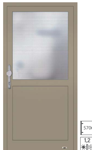
5506-2 ADVANCE 75 mit 100 mm Glasleistsprosse, Verglasung: Wärmeschutzisoliertglas vorne VSG beschichtet, hinten: Mastercarre, alternativ: Float oder Chinchilla weiß, unten wärmegeädammtes; Alu-Sandwich-Panel, 30 mm stark, Oberfläche: Metallic-Feinstruktur Beige
