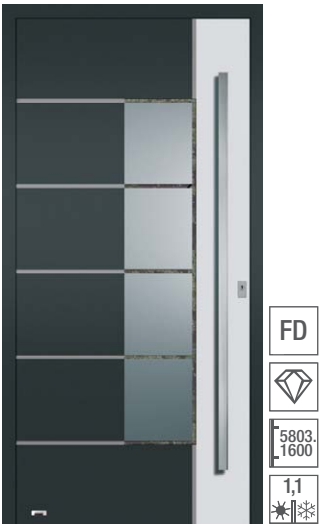
5004 Stoßgriff auf Füllung montiert, vorne: VSG mattiert mit klaren Streifen, hinten: Float beschichtet, Lisenen in NIRO-Design nicht flächenbündig, Oberfläche: Grundfarbe Feinstruktur Nightgrey ca. RAL 7016, Applikation Feinstr. ca. RAL 9016.
