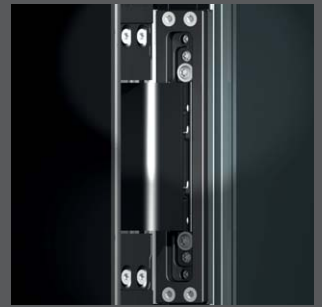
Verdeckt liegende Türbänder Unsere verdeckt liegenden Türbänder werden flächenbündig direkt im Türfalz montiert und sind von außen „unsichtbar“. Somit folgen wir mit diesen Türbändern dem Anspruch auf reduzierte Optik aber maximaler Sicherheit. Bei Verwendung der verdeckt liegenden Türbänder kommt automatisch der Blendrahmen mit 95 mm (bzw. 106mm bei der KÖSTER ADVANCE 108 ) Ansichtsbreite zum Einsatz.
