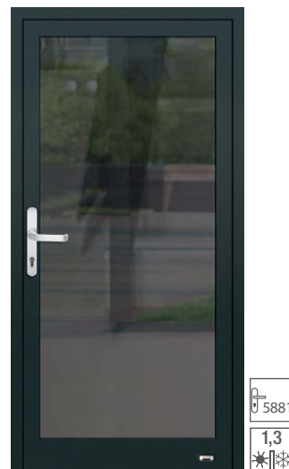
5510 ADVANCE 75 Verglasung: Wärmeschutzisoliertglas, vorne: VSG beschichtet, hinten: Float, alternativ: Mastercarre oder Chinchilla weiß. Oberfläche: FS Nightgrey ca. RAL 7016 beidseitig Drücker 5881 aus Aluminium in weiß oder silberfarbig.
