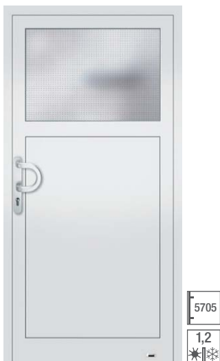
5506-1 ADVANCE 75 mit 100 mm Glasleistsprosse, Verglasung: Wärmeschutzisoliertglas vorne VSG beschichtet, hinten: Mastercarre, alternativ: Float oder Chinchilla weiß, unten wärmegeädammtes; Alu-Sandwich-Panel, 30 mm stark. Oberfläche: RAL 9016 Verkehrsweiß
